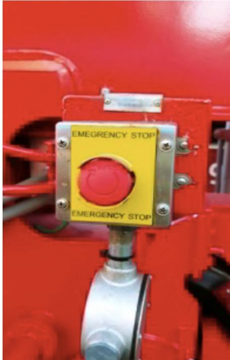
Todos debemos tener en cuenta que las grúas de barco a tierra, las grúas de pórtico con contenedores de caucho y las grúas de pórtico montadas en rieles de contenedores están equipadas con uno o más botones de parada de emergencia a los que se puede acceder a nivel del suelo.
